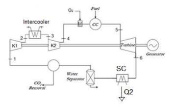
Per lo svolgimento dei calcoli si consideri inoltre una perdita di carico in camera di combustione pari al 5%.
