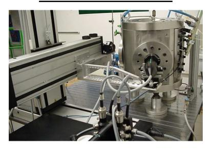
Il presente documento descrive le modalità di esecuzione di prove sperimentali di caratterizzazione del comportamento di sistemi di iniezione in termini sia idraulici (**portata media ed istantanea**), sia di evoluzione dellospray (**shape, velocimetria e sizing**).Le prove sono eseguite presso il Laboratorio di Macchine del Dipartimento di Ingegneria Industriale (DIIN) dell'Universita' degli Studi di Perugia.
