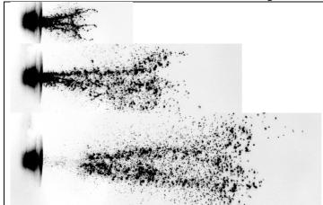
Evoluzione di spray PFI. Immagini ottenute con tecnica Laser-Sheet. Dall'analisi delle immagini si ottengono dati quantitativi sulla penetrazione e sugli angoli
