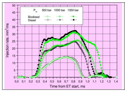
Esempio di curve di portata istantanea; sistema Bosch C.R. alimentato con gasolio e biodiesel, Pinj da 500 bar a 1350 bar.
