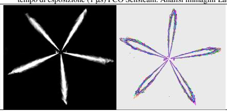
L'acquisizione di immagini relative a tutti i getti consente statistica l'analisi della stabilità e ripetibilità della struttura.In figura: immagine di un singolo evento da iniettore Bosch C.R.. analisi dx. ripetibilità del contour del getto.
